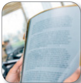
איור 11: ספר אלקטרוני גמיש הבנוי מטרנזיסטורים אורגניים העשויים מחומר פולימרי. התמונה לקוחה מאתר חברת Plastic Logic.
