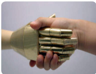
ב) היריעה הגמישה מלופפת סביב יד של רובוט ומעניקה לו יכולת לחוש לחץ. (מאתר אוניברסיטת טוקיו, יפן)
