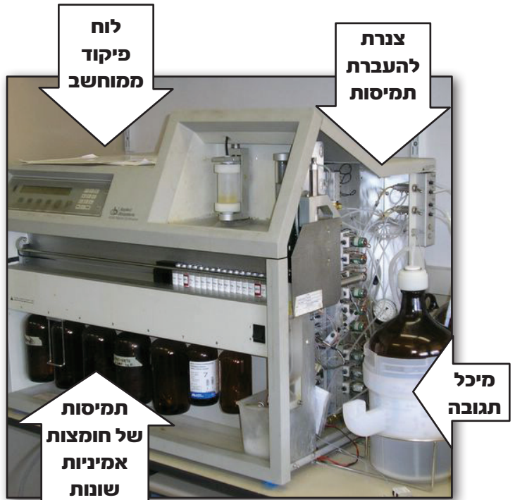
תמונה 1. עורך סינתזת פפטידים (synthesizer).
