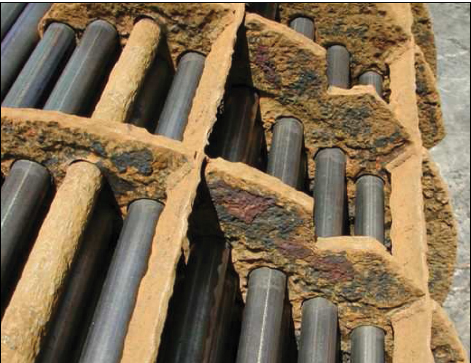
תמונה מס' 6 | קורוזיה גלואנית של מחיצות מפלדה רכה אשר היו במגע עם צינורות טיטניום במיקור (אחרי 3 שנים של שירות)
