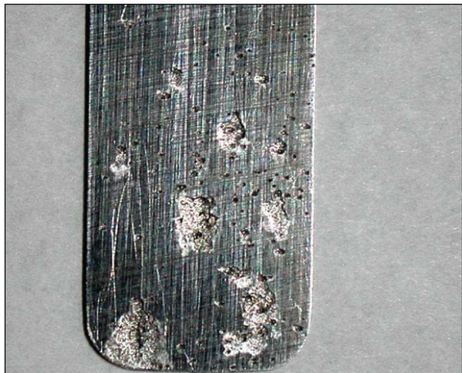
תמונה מס' 2 | פלדה רכה אחרי טבילה בתמיסה מימית שמכילה כלורידים
