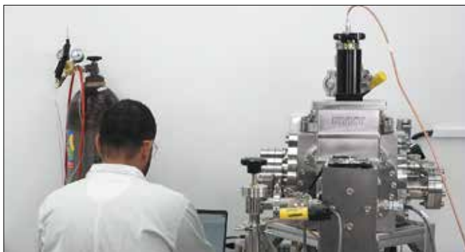
תמונה 2: ריאקטור המפריד את התחמוצות מרגולית הירח לחמצן ומתכות מתוך הסרטון "כימיה בחלל"
