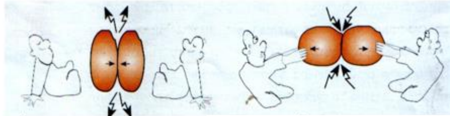
تفكيك الرابط – الطاقة المستوعبة (المبذولة) | إنتاج الرابط – الطاقة المنبعثة
